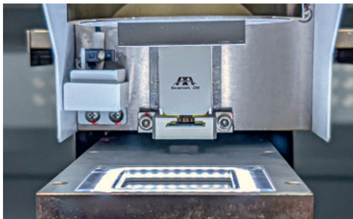
Автоматическое позиционирование при помощи системы технического зрения
