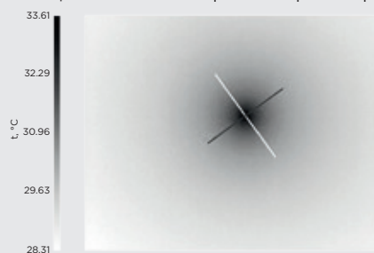
Схема циклического лазерного нагрева образца
